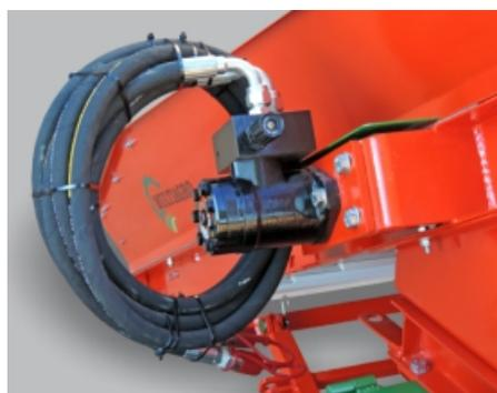
ESTEIRA ACIONADA POR MOTOR HIDRÁULICO
